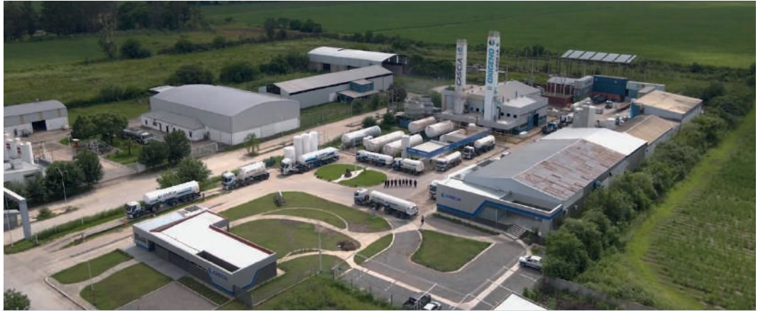
Vista aérea de la planta de Cascia Gases, donde también funcionará la usina generadora de electricidad, a partir de la puesta en marcha de seis motores Cummins (de un mega cada uno) y alimentados con gas natural.
